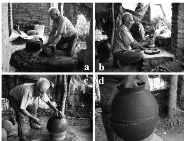
Figura 3 - Proceso de producción: a) amasado, b) torteado, c) moldeado, d) unión de las mitades.
