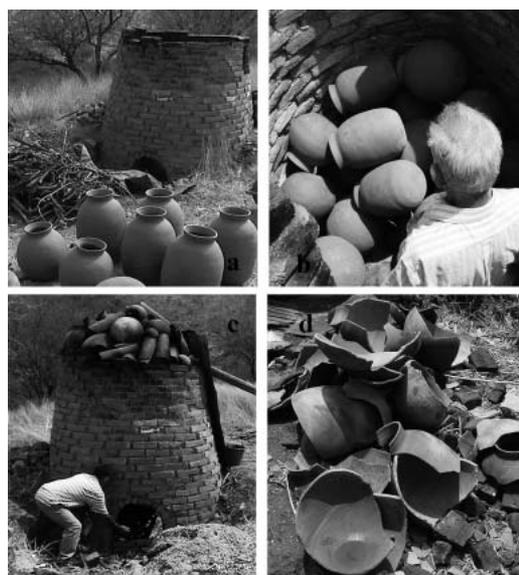
Figura 4 - Quemado de las vasijas: a) ollas que se calientan al sol antes de ser colocadas en el horno; b) acomodo de las ollas en el horno del Taller I; c) Don Samuel alimenta el fuego por la boca del horno; d) fragmentos grandes de ollas utilizados para tapar el horno.
